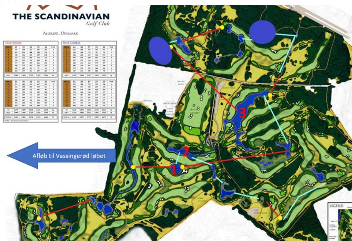
Figur 4.2: Plan over vandingsanlægget på The Scandinavian ApS
